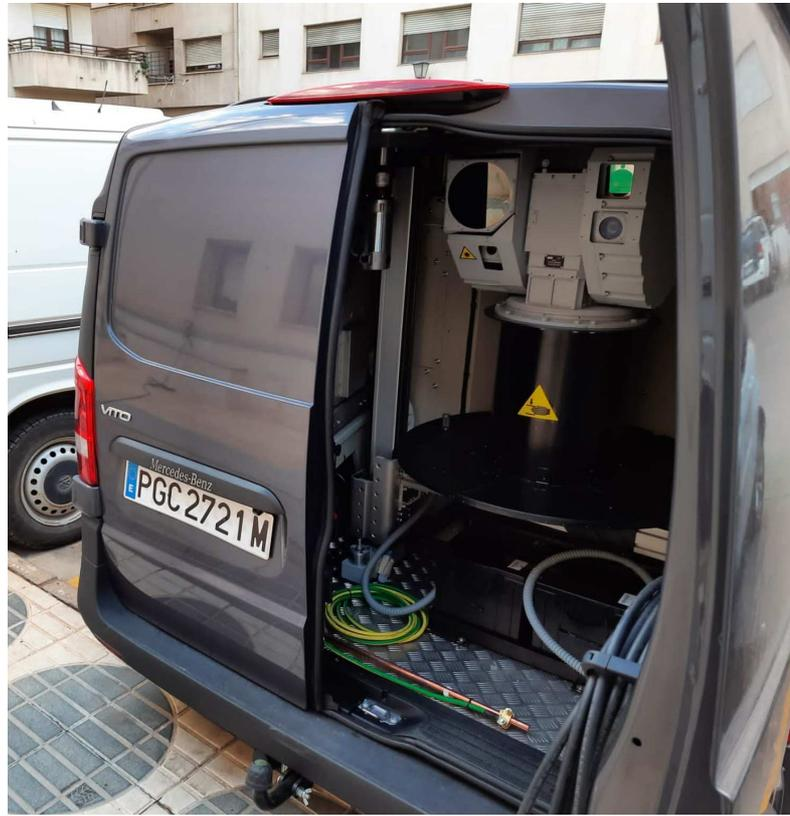
Imagen 10. Exterior e interior vehículo todoterreno con cámara térmica (ATV).
